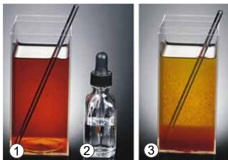
Рис. 5.2. Колоїдний розчин ферум(III) гідроксиду (1), його зсідання під дією водного розчину натрій хлориду (2) й осадження (3)
