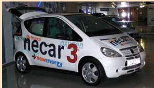
Рис. 33.1. Автомобіль Mercedes Benz Nekar-3 із силовою установкою на прямому метанольному паливному елементі. 2006 рік
