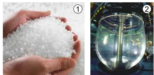
Рис. 29.2. 1. Гранули поліетилену. З його розтопу в різні способи легко формувати вироби. 2. Виготовлення поліетиленової плівки
