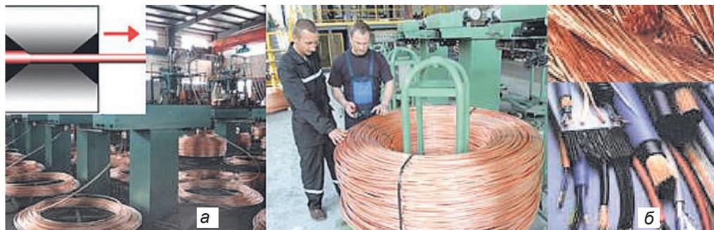
Рис. 35. Виды одножильного и многожильного медного провода: а – без изоляционных оболочек; б – в изоляционных оболочках
