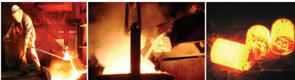
Рис. 25. Выплавление заготовок сырья (слитков) из меди
