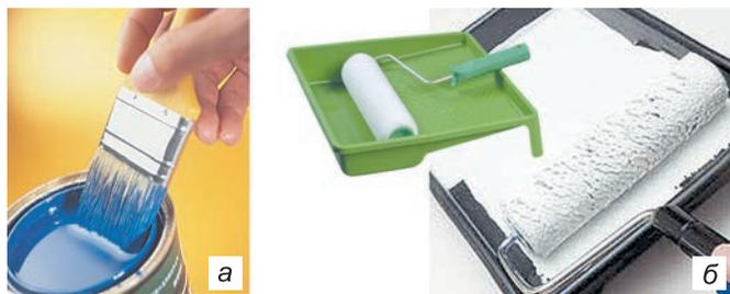
Рис. 166. Подготовка инструментов для нанесения краски: а – флейцем; б – валиком
