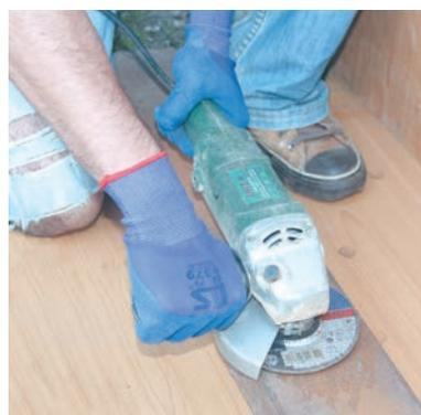
Рис. 154. Очистка от ржавчины электрифицированным инструментом
