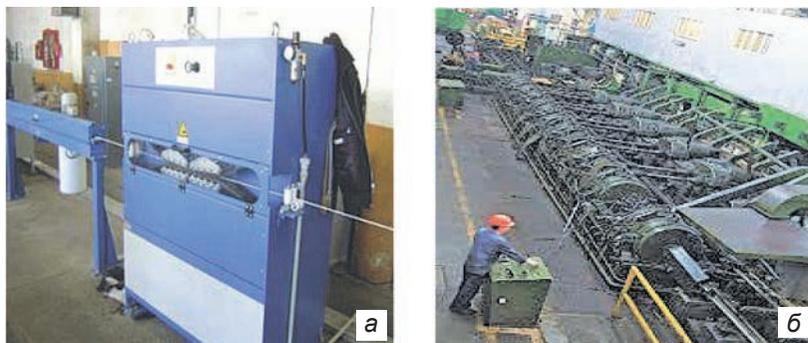
Рис. 36. Автоматическая (а) и полуавтоматическая (б) линии производства провода
