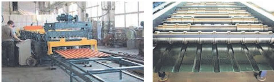
Рис. 111. Гнутьё металла на профилегибочном стане
