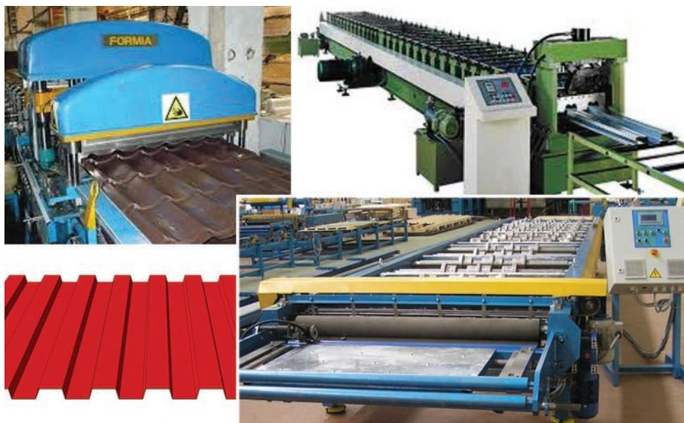
Рис. 17. Формирование листового металла с разным профилем на прокатном стане
