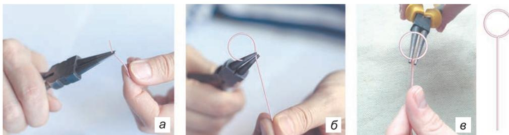
Рис. 140. Последовательность гнутья проволочного кольца круглогубцами
