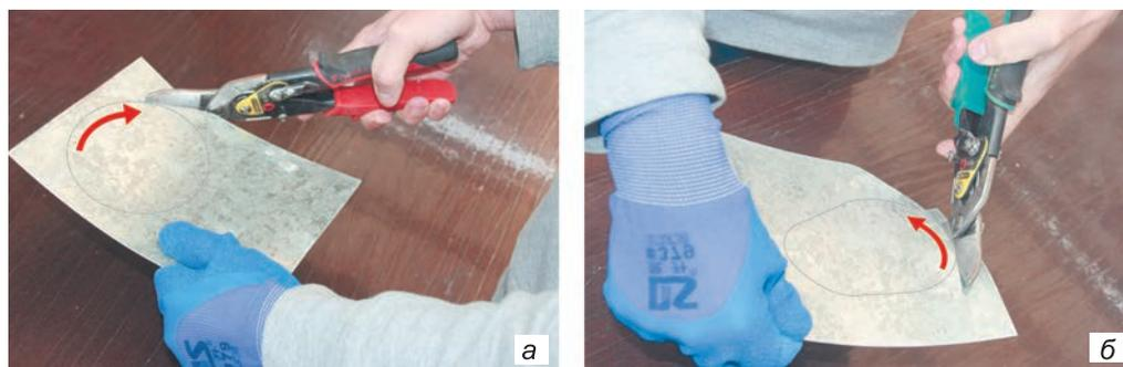
Рис. 75. Приёмы работы ножницами: а – правыми; б – левыми
