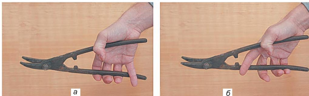
Рис. 76. Правильная хватка слесарных ножниц: а – с разведением рукояток мизинцем; б – с разведением рукояток указательным пальцем
