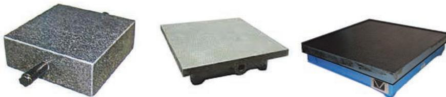
Рис. 60. Виды разметочных плит
