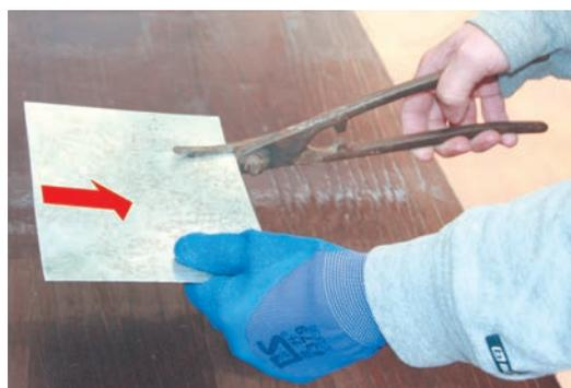
Рис. 74. Приём резания по прямой линии
