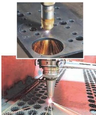
Рис. 84. Резание металла лазером
