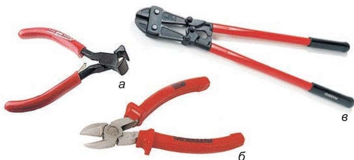
Рис. 132. Виды кусачек для резания стального провода:
