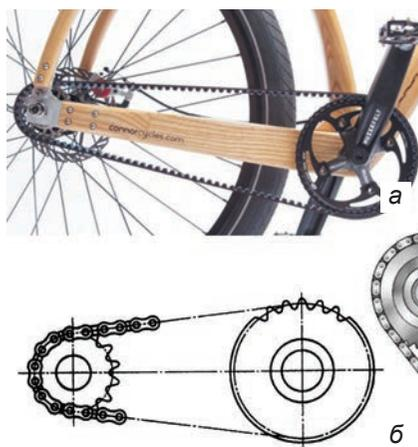
Рис. 181. Цепная передача велосипеда: а – общий вид; б – фрагмент передачи
