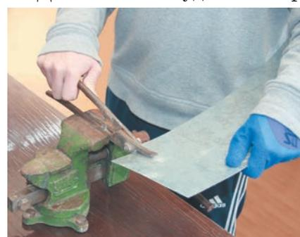
Рис. 77. Закрепление ножниц в тисках
