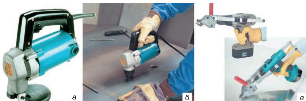
Рис. 80. Ручные электрические ножницы: а – общий вид; б – приём резания; в – насадка-ножницы
