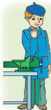
Рис. 10. Определение соответствия высоты слесарного станка росту работающего
