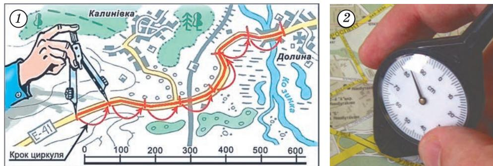
Мал. 32. Вимірювання відстаней за допомогою циркуля (1) і курвіметра (2)
