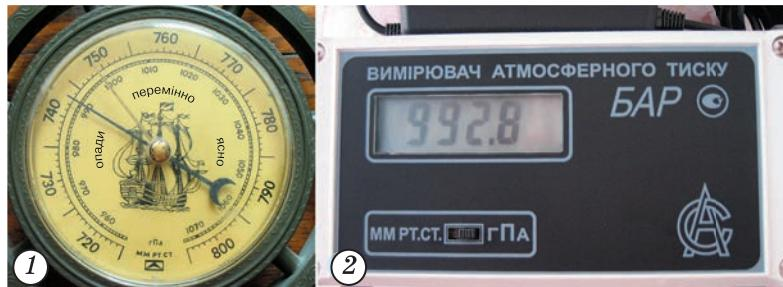
Мал. 93. Барометр-анероїд (1), електронний барометр (2)
