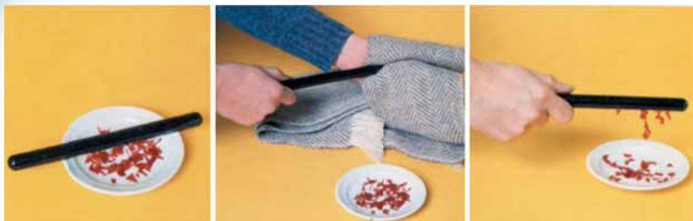
Мал. 43. Ебонітова паличка після натирання вовняною тканиною притягує клаптки паперу
