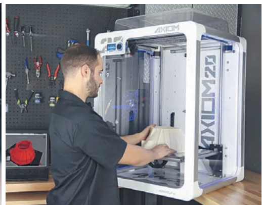
Мал. 3.41. Створення протеза грудної клітки у 3D-принтері
