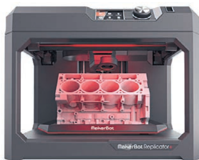
Мал. 3.43. Створення моделі блока циліндрів автомобіля у 3D-принтері
