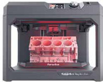
Мал. 3.43. Створення моделі блока циліндрів автомобіля у 3D-принтері
