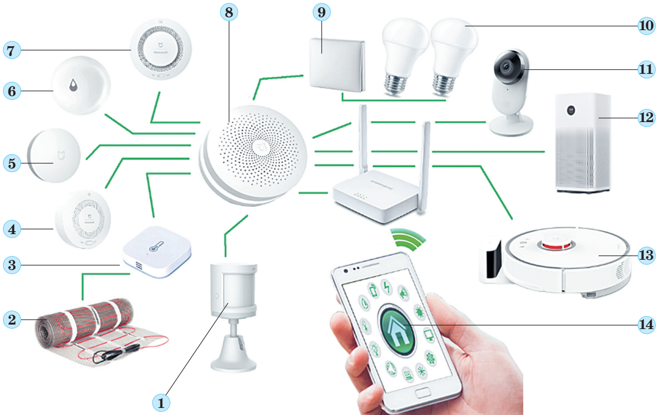
Мал. 1.1. Схема керування цифровими пристроями розумного будинку: 1 – Датчик руху; 2 – Тепла підлога; 3 – Датчик температури; 4 – Датчик витoku газу; 5 – Бездротова кнопка; 6 – Датчик наявності води; 7 – Датчик диму; 8 – Хаб будинку; 9 – Бездротовий вимикач; 10 – «Розумні» лампи; 11 – Вебкамера; 12 – Очищувач повітря; 13 – Робот-пилосос; 14 – Смартфон з програмою керування
