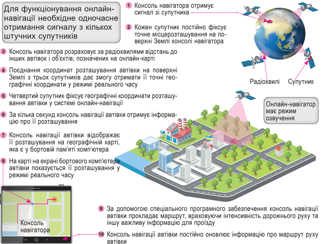
Мал. 10.2. Схема функціонування онлайн-навігатора автівок
