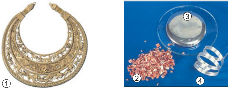
Рис. 12.2. Метали. 1. Пектораль із Товстої могили – нагрудна прикраса скіфського царя (IV століття до н. е.). Матеріал – золото Au. 2. Мідь Cu – метал, відомий людству з давніх-давен. 3. Ртуть Hg – один з небагатьох металів, які за звичайних умов є рідинами. 4. Магній Mg – сріблясто-білий пластичний метал
