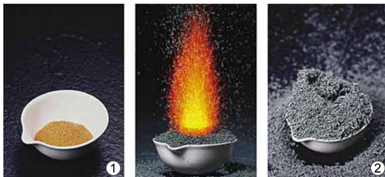
Рис. 33.2. Хімічний вулкан. Хром(III) оксид (1) – один з продуктів розкладання амоній дихромату (2)
