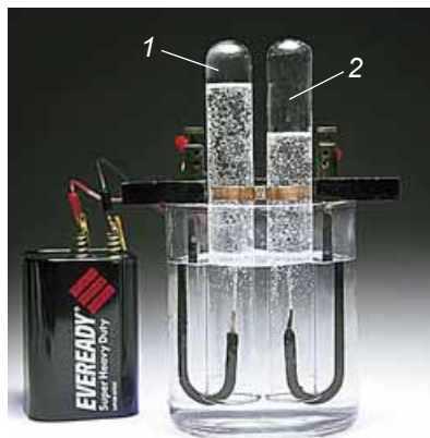
Рис. 21.3. Розкладання води електричним струмом
