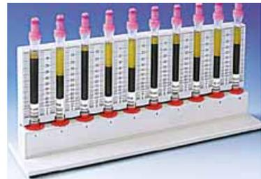
Рис. 70. Так в лабораториях определяют скорость оседания эритроцитов (СОЭ)
