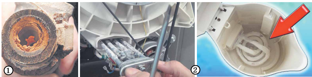
Рис. 28.2. Накип у трубі (1) та на поверхні нагрівальних елементів (2)
