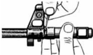
4. Відокремити дульне гальмо-компенсатор
