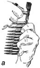
Спорядження обойми патронами: а – з перехідником; б – без перехідника
