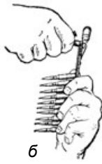
Спорядження обойми патронами: а – з перехідником; б – без перехідника
