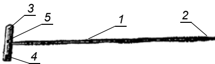
Приладдя автомата, підготовлене для чистки: 1 – шомпол; 2 – протирка; 3 – пенал; 4 – викрутка; 5 – головка шомпола
