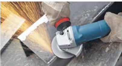
Мал. 27. Відлітання іскор від диска під час шліфування металу
