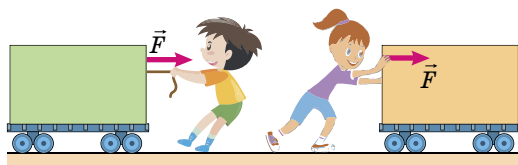
Мал. 55. Рух тіла не залежить від точки прикладання сили, а залежить від лінії її дії
