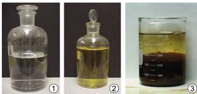
Рис. 25.4. Реакція між ферум(III) хлоридом і натрій гідроксидом у розчині. 1. Розчин натрій гідроксиду. 2. Розчин ферум(III) хлориду. 3. Осад ферум(III) гідроксиду. Завдання. Наведіть приклади лугів та солей Феруму(III), у результаті взаємодії яких у розчині можна добути ферум(III) гідроксид. За потреби використайте таблицю розчинності. Складіть хімічні рівняння відповідних реакцій, класифікуйте їх
